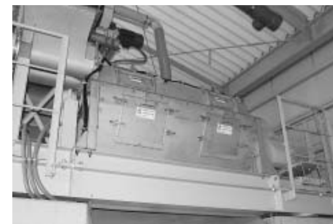
食品と容器を自動的に分別するバック分離機
